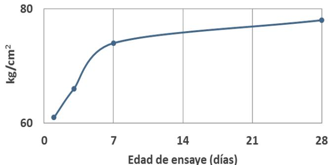
**Nota:** Los datos incluidos fueron obtenidos en condiciones de laboratorio, 24 °C +/- 1 y 50% de humedad relativa. Los datos señalados para tiempo de fraguado y transitable, pueden variar en función de condiciones ambientales y el espesor aplicado.
