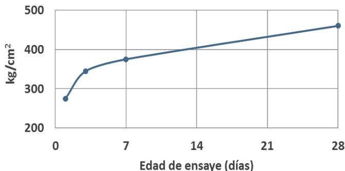
Resistencia a la flexión ASTM-C-348
