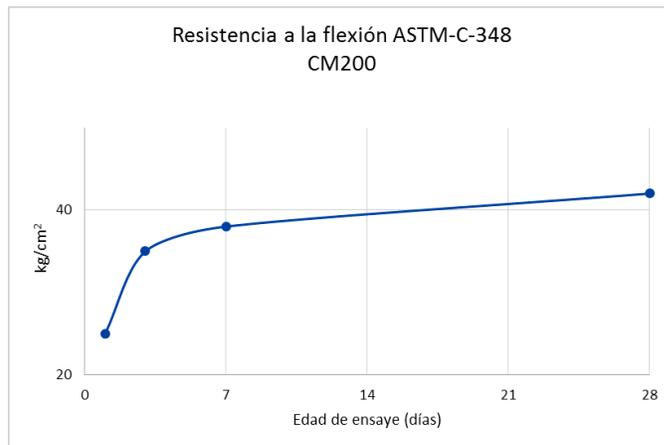
**Nota:** Los datos incluidos fueron obtenidos en condiciones de laboratorio, 24 °C +/- 1 y 50% de humedad relativa. Los datos señalados para tiempo de fraguados y transitable, pueden variar en función de condiciones ambientales y el espesor aplicado.
